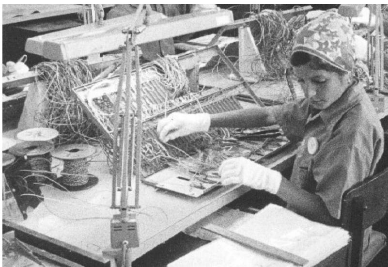
Figura 2.2 Alambraje de un rack de CID 201B por una estudiante de la Escuela LENIN
