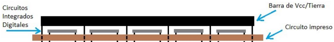
Figura 4.2 Vista lateral de una tarjeta con barras de Vcc y tierra
